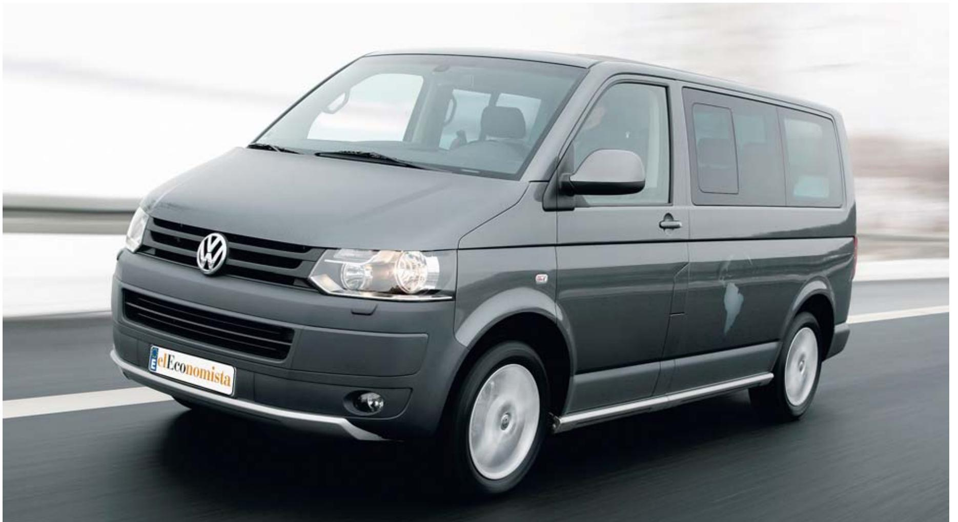
**FICHA TÉCNICA:** Motor: eléctrico. Potencia: 47 CV ♦ Autonomía: 100 kilómetros ♦ Tiempo de carga: 4 horas enchufado a la red doméstica; 1 hora con sistema de carga rápida
