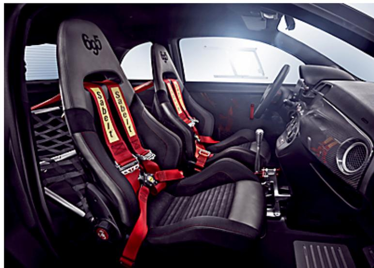
asientos *bacquet* de competición con arneses de cuatro puntos de anclaje, una pantalla multifunción que contiene información relativa a la gestión del motor, pedales y reposapiés de aluminio y, lo más sorprendente de todo, un cambio manual tipo *Dog Ring* que permite realizar las transiciones entre marchas mucho más rápido de lo habitual, sin necesidad incluso de pisar el pedal del embrague si las manos que lo manejan son expertas.
