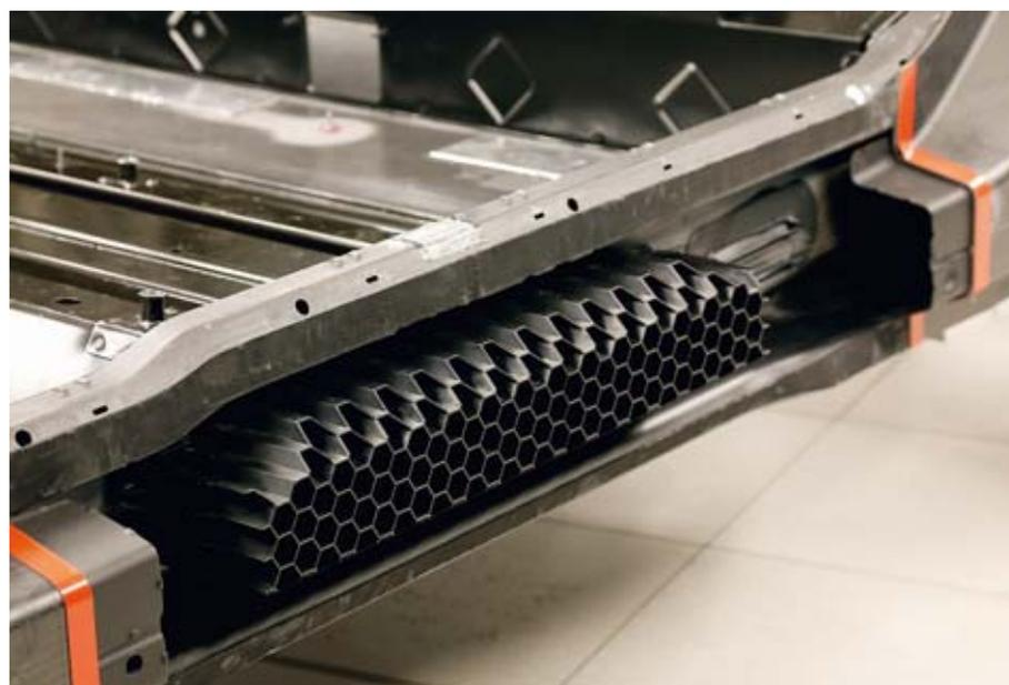
**El i3 no tiene pilar B, pero una pieza termoplástica absorbe impactos laterales.**
