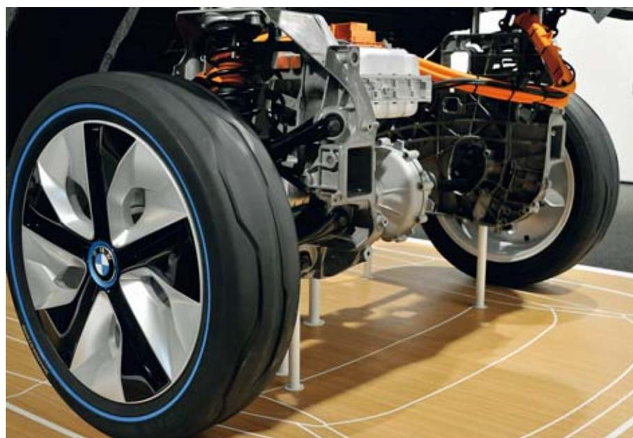
**El motor eléctrico de 170 CV de potencia, está colocado sobre el eje posterior.**
