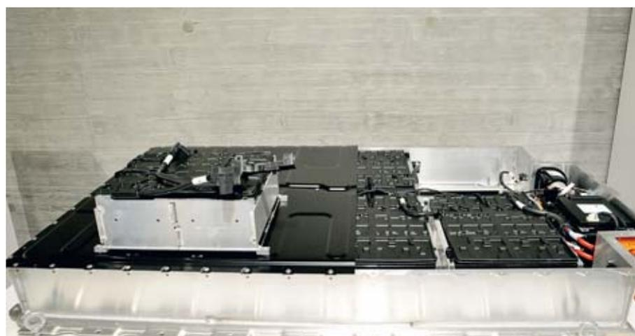
**La batería del BMW i3 tiene un peso de 230 kilos y una capacidad de 22 kWh.**
