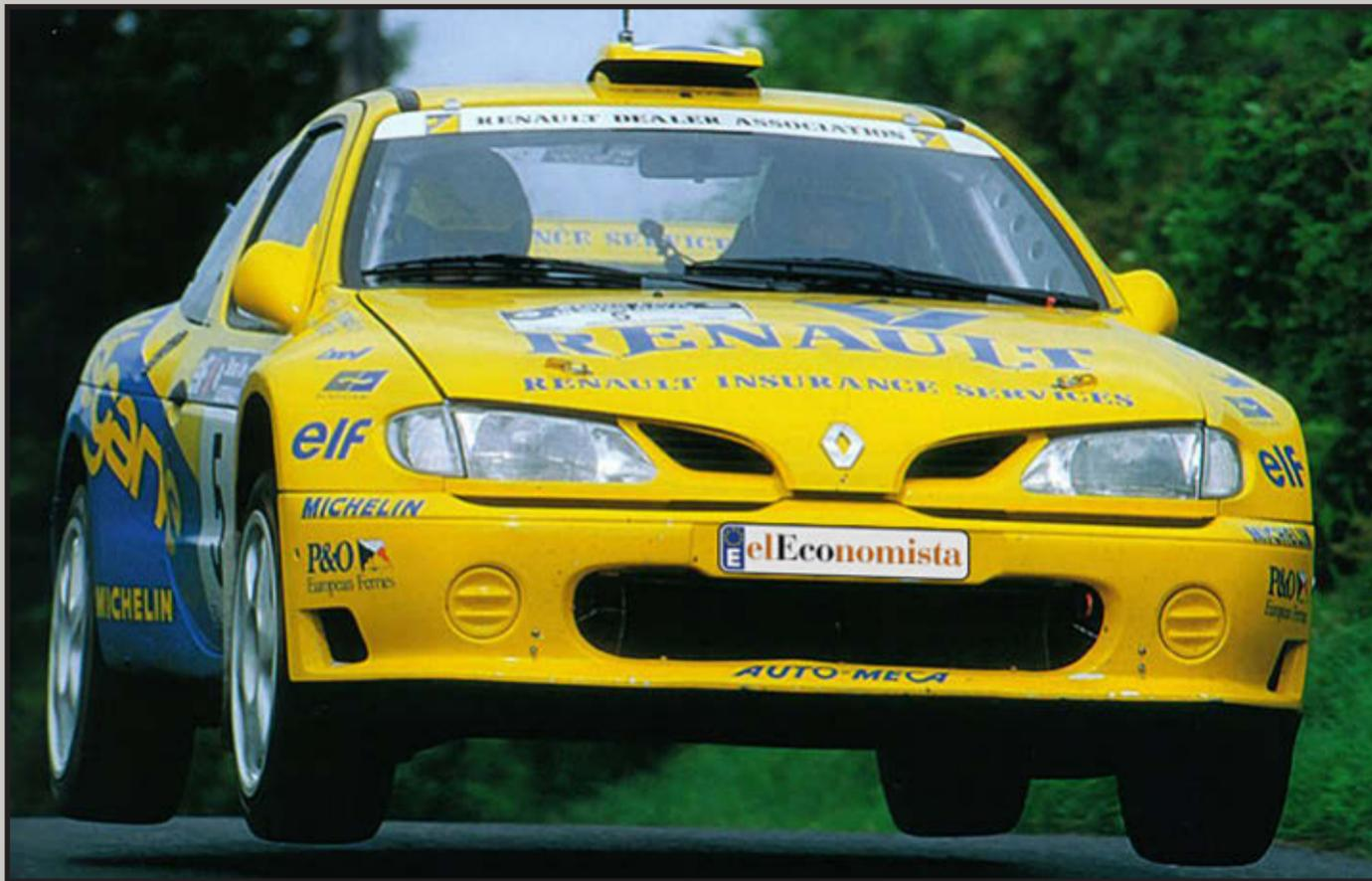
El Renault Mégane Maxi debutó en los rallyes en 1996 con un motor atmosférico de cuatro cilindros, dos litros y 275 CV.
