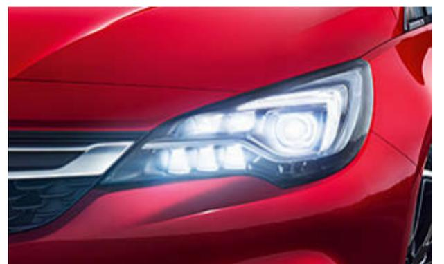
Compuesto por 16 diodos, el IntelliLux LED de Opel funciona con las luces largas de carretera. Cuando es posible, estas abarcan todo el haz de luz; si existe riesgo de cegar a otros usuarios, el sistema apaga o atenúa los leds necesarios para evitarlo.
