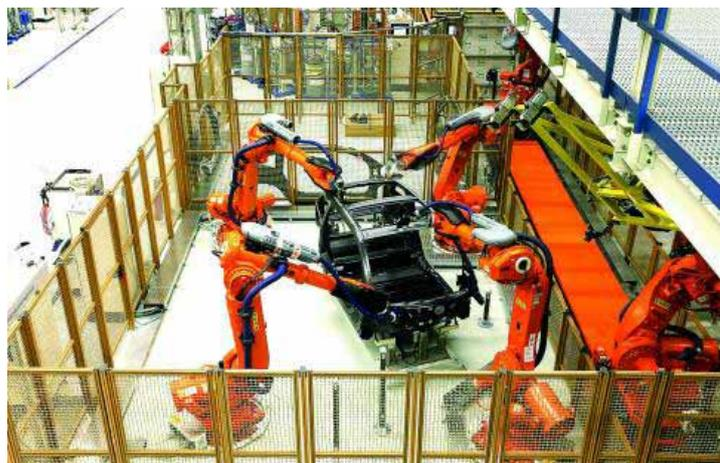
Un grupo de robots ultimam el montaje del "esqueleto" de fibra de carbono del módulo Life del i3, con las piezas pegadas y no soldadas
