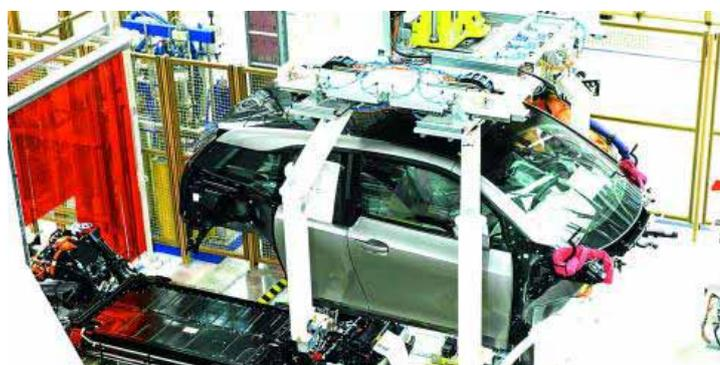
El momento más importante del proceso de fabricación, cuando los módulos Drive y Life se funden en lo que ya, sólo a falta de detalles, se ha convertido en un nuevo i3
