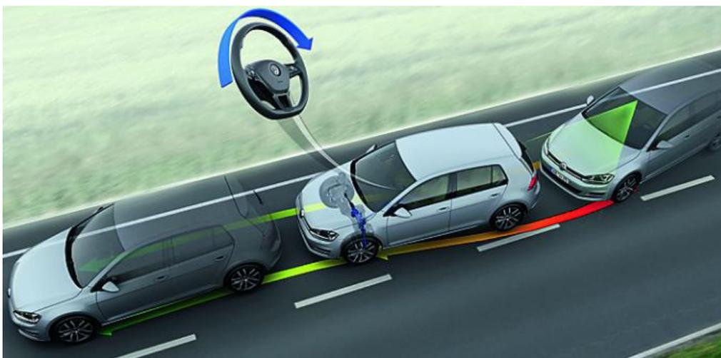
La nueva versión del LANE ASSIST utiliza una cámara delante del retrovisor interior que detecta las marcas de los carriles. Cualquier cambio de carril sin activar el intermitente hace que el coche corrija la dirección de una forma suave.
